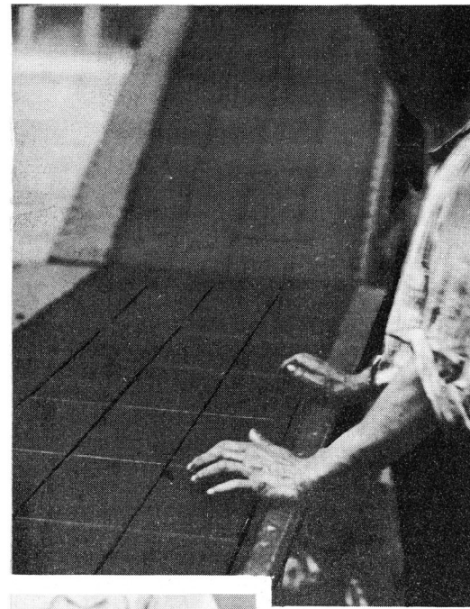
La pâte sortant des laminoirs est coupée en carrés sur des tables chauffantes, prête à être pressée.
